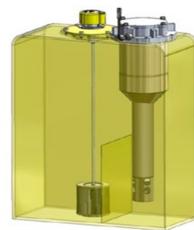
エアレーション対策を取り入れたフィルタケースアセンブリのイメージ図
